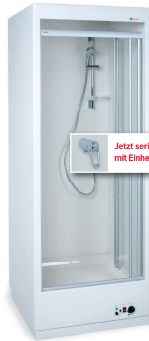
Fertigdusche SOUVERÄN mit Echtglas-Gleitklapptür, 16-l-Warmwasser- speicher (dadurch 32 cm Einstieg) und Ab- wasserpumpe (Art.-Nr. 330.88.N, 901, 921)
