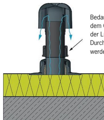
Bedarfsweise Lüftung der Dämmung mit dem Quetschverschraubungsring, der nach der Lüftung durch die Schraubkappe der Durchgriffvorrichtung wieder verschlossen werden kann.
