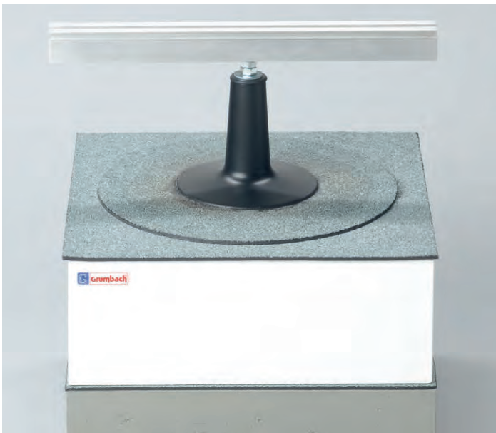
Befestigungsdurchführung aus PUR (schwarz) wärmegeämmt, FCKW-frei, mit integrierter Gummidichtung und eingeschäumter Anschlussbahn (Bitumen, PVC oder Sonderfolie).
