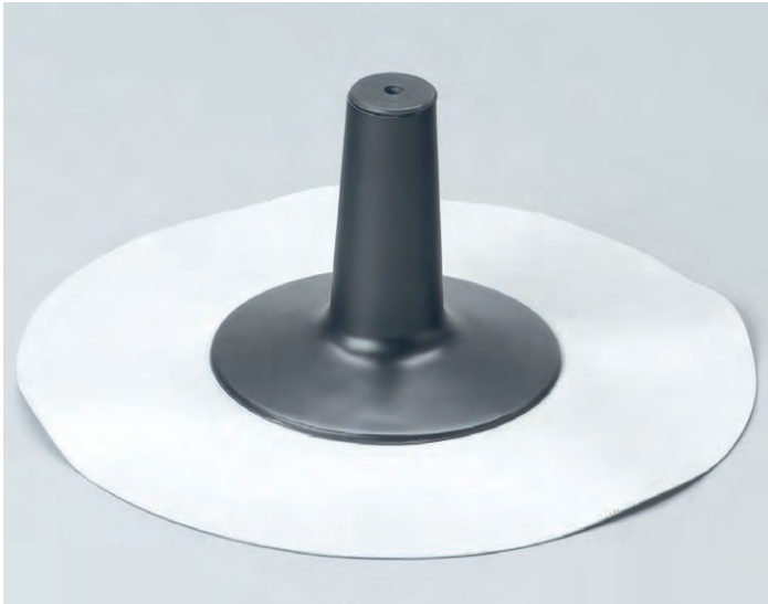
Befestigungsdurchführung aus PUR (schwarz) wärmegeämmt, FCKW-frei, mit integrierter Gummidichtung und eingeschäumter Anschlussbahn (Bitumen, PVC oder Sonderfolie).
