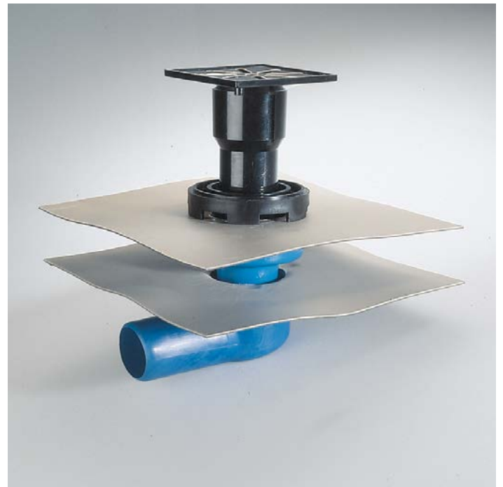
Balkon-Gully waagrecht DN 50 mit Klebekragen , Aufstockelement mit Klebekragen, Kleinkiesfang und begehbarem Stufen-Einlaufteil.
