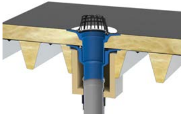
Brandschutzverkleidung mit Universal-Gully und Aufstockelement im Trapezblechdach mit Warmdachaufbau.
