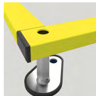
Stellfüße zum einfachen Ausrichten und Befestigen; mit Gummilager für die Entkopplung des Körperschalls. Die Anzahl der Stellfüße richtet sich nach der Größe des Rahmens.
