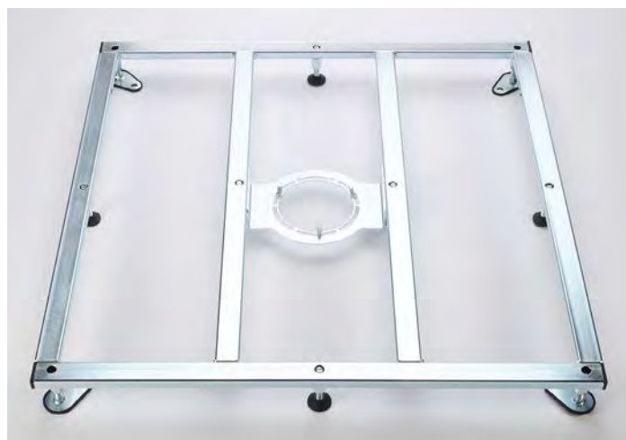
Tragrahmen für Duschbodenelemente 90x90 cm, verzinkt, mit 10 Stellfüßen, Ansicht von oben
