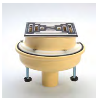
Badablauf aus PUR, senkrecht oder waagrecht, passend zum jeweiligen Duschbodenelement (bitte nach Bedarf dazu bestellen, siehe S. 46)
