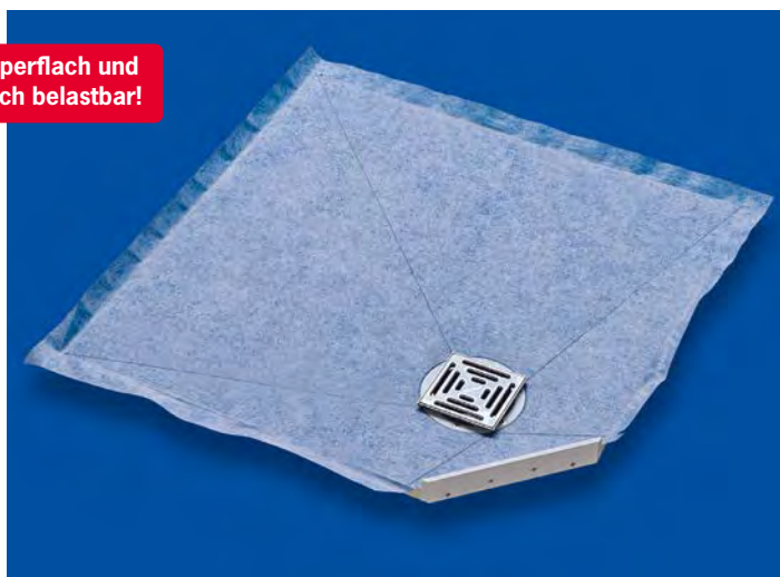
Eck-Duschbodenelement »superflach« aus PUR 900x900x25 mm mit dezentralem Ablauf, passend zur Eck-Installationsplatte aus PUR
