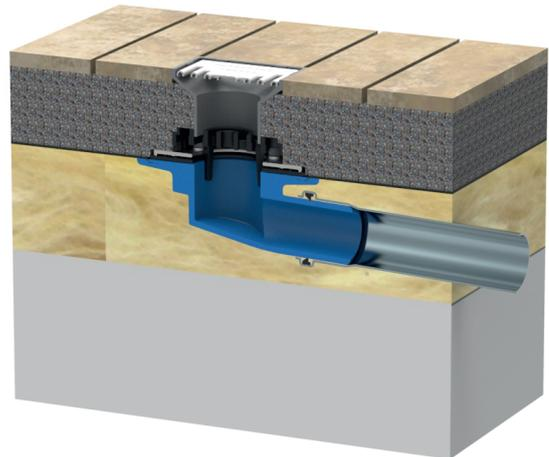
Balkon-Gully waagrecht DN 50 in der Wärmedämmung mit Kleinkiesfang und Einlaufteil im Plattenbelag auf der Terrasse.
