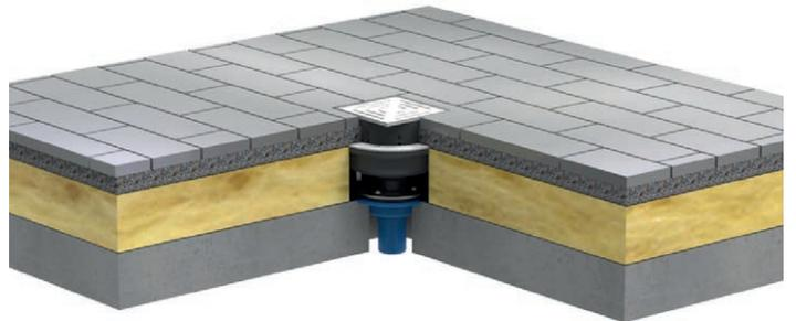
Eingebauter Balkon-Gully DN 50 als Grundelement und eingestecktem Balkon-Komplettablauf DN 50 als Aufstockelement im Warmdach verbaut. Der höhenverstellbare Einlegerost dient als Abschluss zum Plattenbelag.
