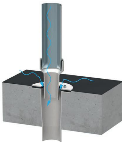
Durch Anheben und Arretieren der unteren Rohraufnahme wird die Rohrmuffe auf den Stützen des oberen Ablaufs aufgesteckt.
