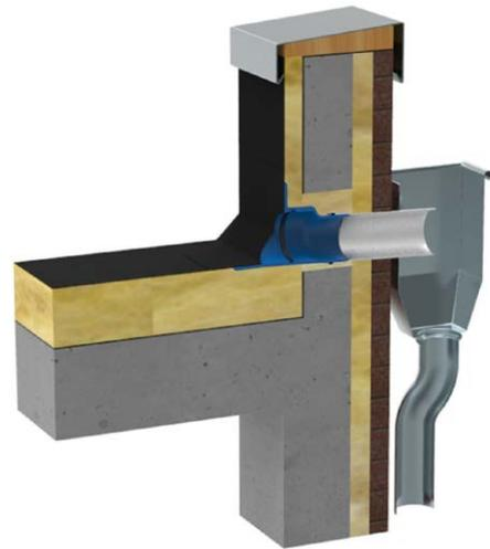
Attika-Balkonablauf (Art.-Nr. 3444.BIT) mit Dampfsperren-Anschlussmanschette in der Dampfsperre und Wasserfangkasten. **Um Frostschäden zu vermeiden, empfehlen wir den Einsatz unseres Begleitheizungssystems (s. S. 74).**
