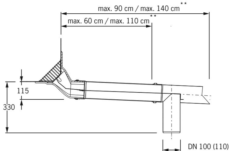
\*\*Langversion mit 2. Edelstahlrohr und verlängertem Leitblech
