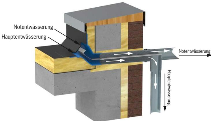
Attika-Super-2-Gully mit Stromteilabzweig im Warmdach.
