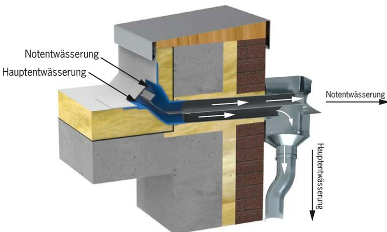
Attika-Super-2-Gully mit Wasserfangkasten im Warmdach.
