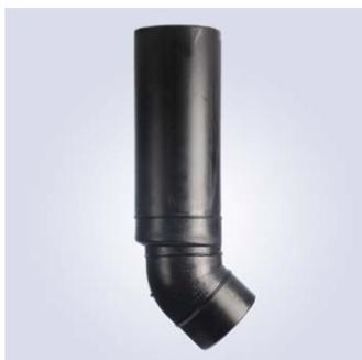
Das Notentwässerungsrohr aus stabilen PE-Rohr-Formstücken wird einfach in den Kombi-Gully II eingesteckt. Das Rohr wird bei der Bestellung je nach vorhandener Aufstockung bzw. gewünschter Anstauhöhe in der erforderlichen Länge gefertigt.
