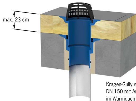
Kragen-Gully senkrecht DN 150 mit Aufstockelement im Warmdach
