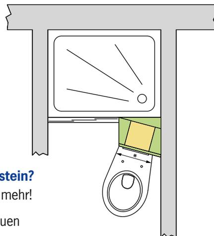
Die 15°-Winkelemente des SLIM-BLOCK ermöglichen eine effiziente Nutzung enger Grundrisse (»Schlauchbäder«) mit der Installation eines Wand-WCs.
