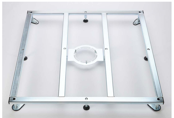
Tragrahmen für Duschbodenelemente 90x90 cm, verzinkt, mit 10 Stellfüßen, Ansicht von oben
