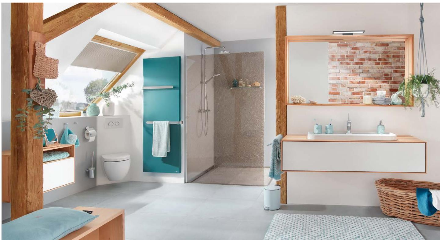
Ein ungenutzter Dachboden wird zur »Oase«. Die verfügbaren niedrigen Bauhöhen des **Grumbach Eck-WC-Steins** gestatten einen Einbau am Drempel. Der großzügige, bodengleiche Duschbereich ist mit Hilfe des **Duschbodenelements 120x120 cm aus PUR mit Rinnenentwässerung und höhenverstellbarer Seitenblende** realisiert.
