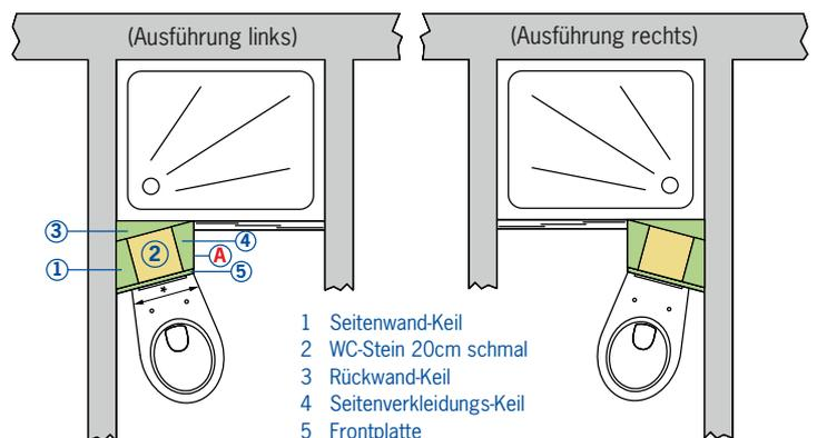
\* max. WC-Breite an der Befestigungsseite von 280 mm. Bei breiteren WC-Becken muss die Fläche A mit Bauplatten aufgedoppelt werden.
