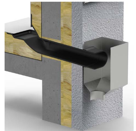
Wasserfangkasten mit Dichtmanschette passend zum Attika-Jumbo-Gully (Art.-Nr. 3436.N)
